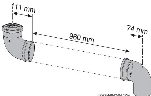
Fig. 6 90° Bend offset dimensions
