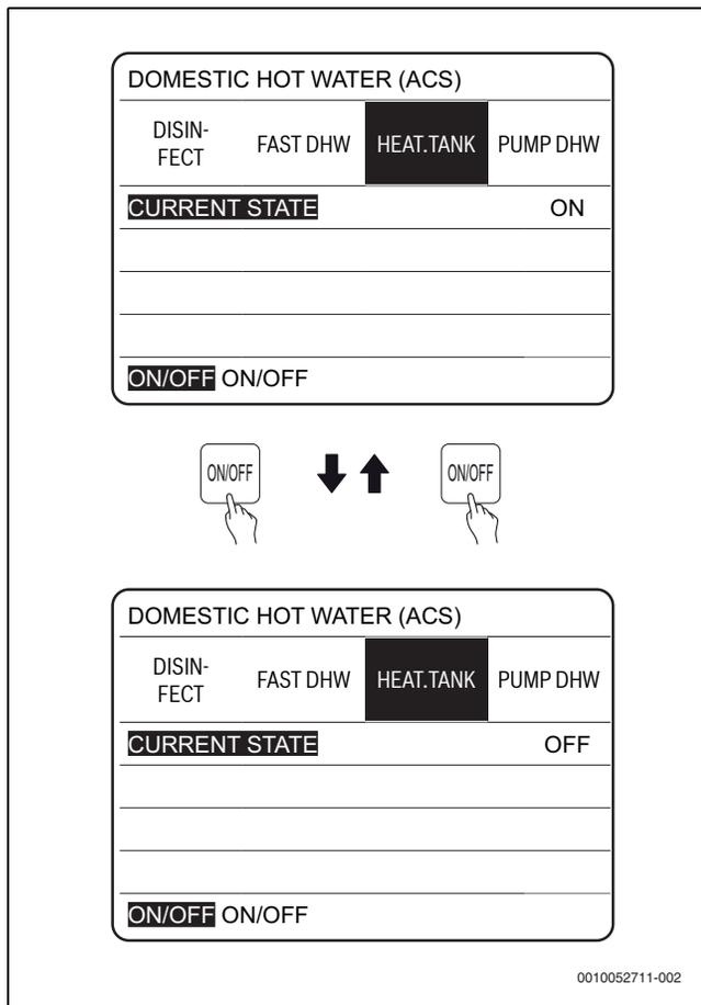
Fig. 189 TANK HEAT
