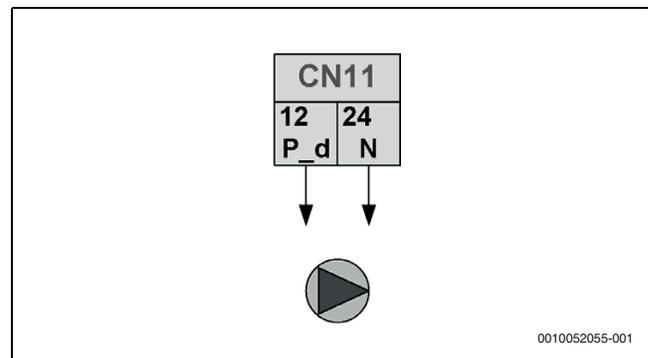
Fig. 79 DHW pump, type 2 control signal
