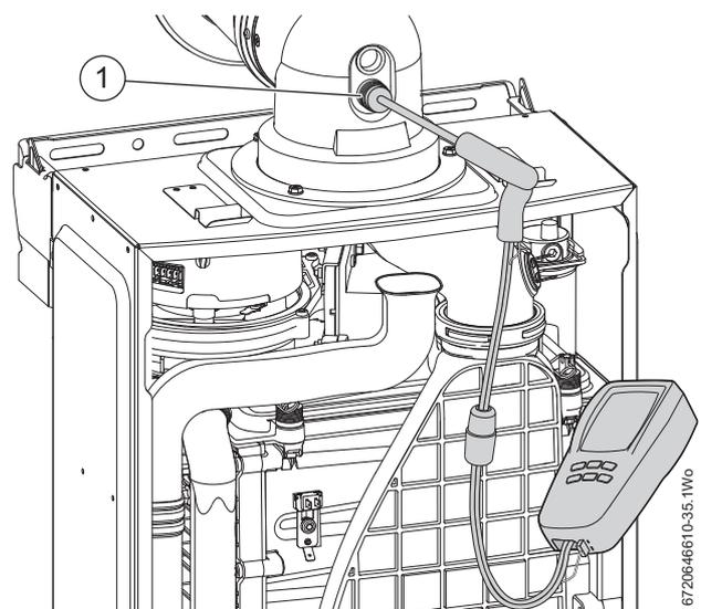
Fig. 76 Combustion test
