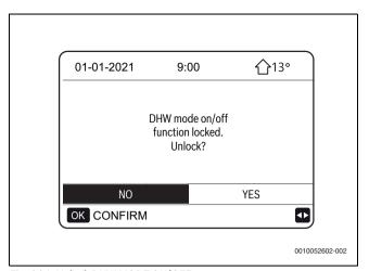
Fig. 221 Unlock DHW MODE ON/OFF
