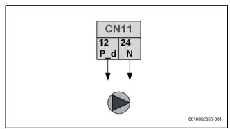
Fig. 79 DHW pump, type 2 control signal [P\_d] DHW circulation pump
