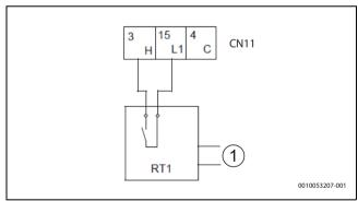
Fig. 101 Zone thermostat – Method B
