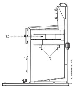
Fig. 86 Baffle positioning
