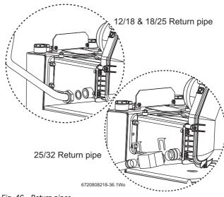
Fig. 46 Return pipes
