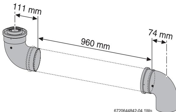
Fig. 6 90° Bend offset dimensions
